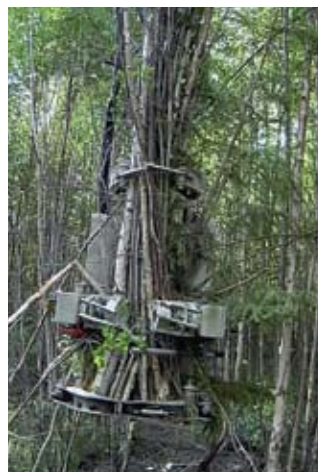
Mehanizētā meža kopšanā koku nozāģēšanai un savākšanai pielieto griezējgalvas
